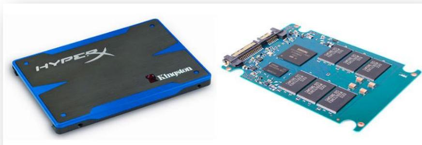
Como ves ha perdido todas sus partes mecánicas y ahora están compuestos por chips y los típicos conectores para que puedas conectarlo al ordenador.
